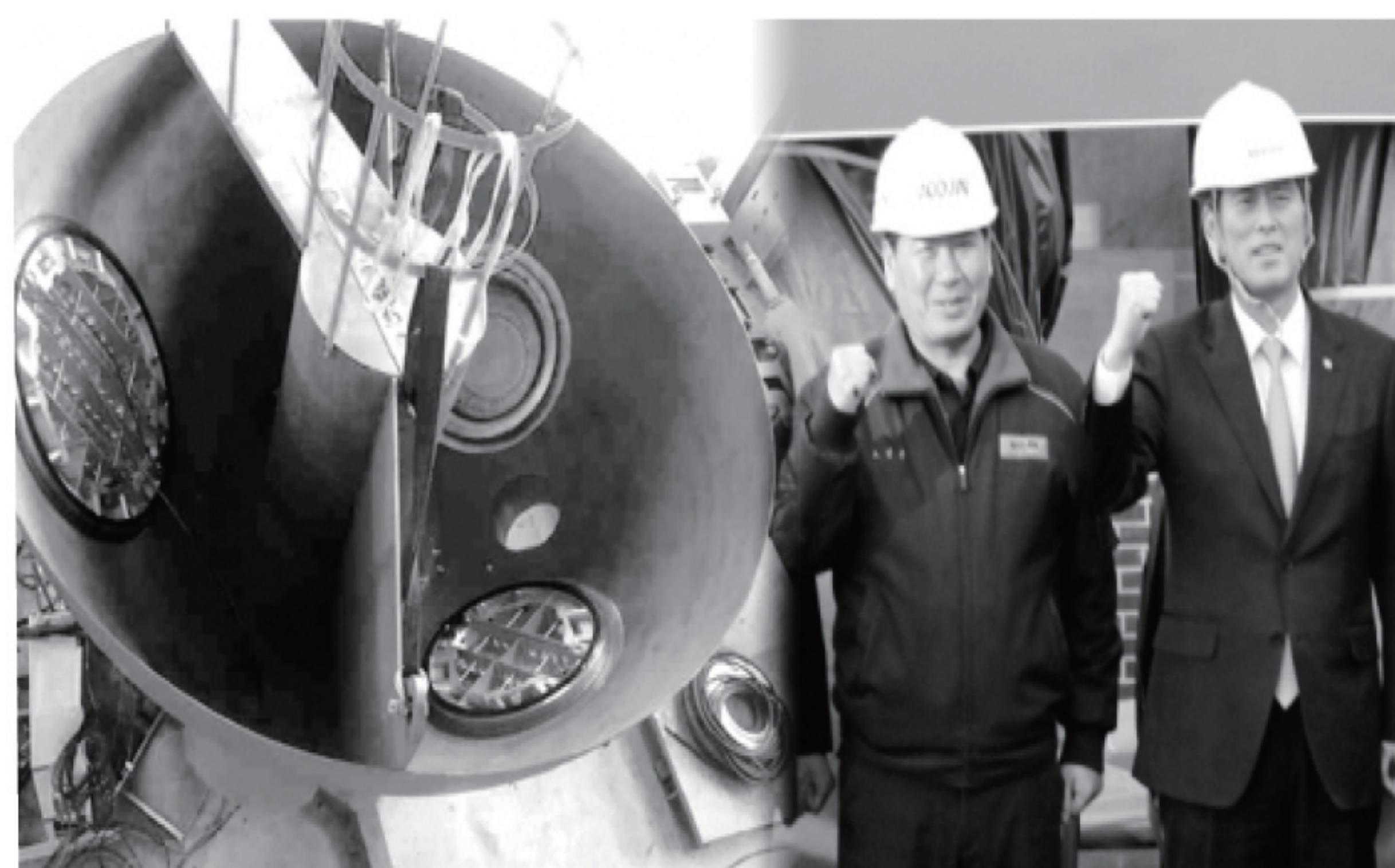
무진기연(대표이사 조성은)은 '증기발생기 노즐댐'을 세계에서 두 번째로 개발에 성공하는 쾌거를 거뒀다. 한수원과 상생을 통해 이뤄낸 성과물로 '증기발생기 노즐댐'은 가동 중인 원전을 유지보수할 때 증기발생기 노즐입구에 임시로 설치하는 설비로, 수조의 냉각수가 증기발생기 내로 유입을 차단시켜 증기발생기 내부 작업자의 안전을 도모하고 건전성을 확보하기 위한
